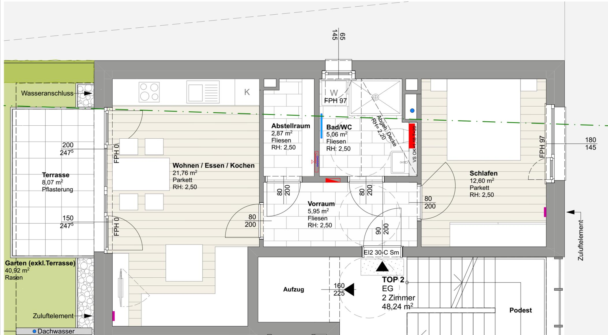
Einrichtungsgegenstände in Bereichen vor Zuluftelementen dürfen eine maximale Höhe von 2,10m nicht überschreiten. Einrichtungsgegenstände sind von der Außenwänden um mind. 5cm abzurücken.
